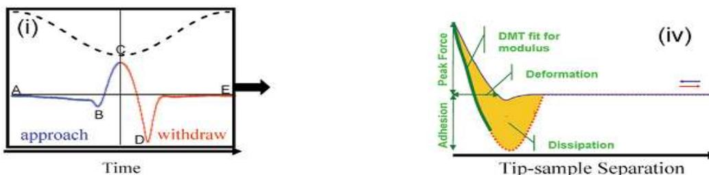
Рис. 6. Силовая кривая (i), принцип расчета физических характеристик материала (iv) по форме силовой кривой. [Application Note #128. "Quantitative Mechanical Property Mapping at the Nanoscale with PeakForce QNM". Bruker Corporation, [www.bruker.com](http://www.bruker.com)].
