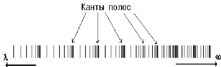
Рис.6. Канты полос V^* - прогрессии, V^* > V .
